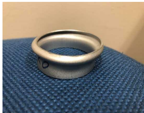
写真 12 1.0mm 実験後のアルミ円筒 (落下高さ : 200mm)
