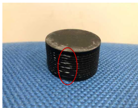
写真 13 合成部材を解体した後の PRF (落下高さ : 200mm)
