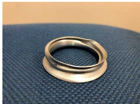
写真 11 0.6mm 実験後のアルミ円筒 (落下高さ : 200mm)
