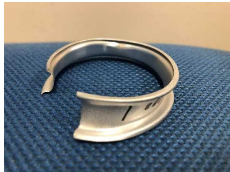
写真 10 0.4mm 実験後のアルミ円筒 (落下高さ : 200mm)
