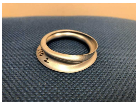
写真 16 0.8mm 実験後のアルミ円筒 (落下高さ 250mm)
