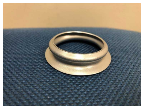
写真 17 1.0mm 実験後のアルミ円筒 (落下高さ 250mm)
