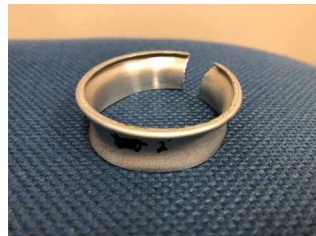
写真 7 0.6mm 実験後のアルミ円筒 (落下高さ : 150mm)
