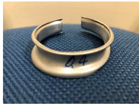
写真 6 0.4mm 実験後のアルミ円筒 (落下高さ：150mm)
