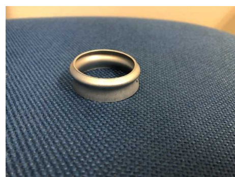
写真 9 1.0mm 実験後のアルミ円筒 (落下高さ：150mm)
