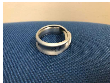
写真 8 0.8mm 実験後のアルミ円筒 (落下高さ：150mm)
