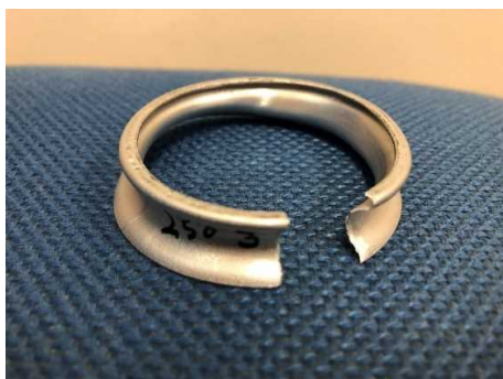
写真 15 0.6mm 実験後のアルミ円筒 (落下高さ：250mm)
