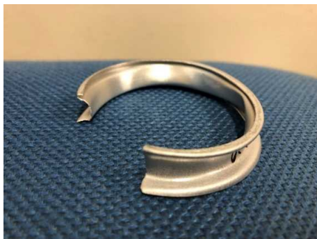
写真 14 0.4mm 実験後のアルミ円筒 (落下高さ：250mm)
