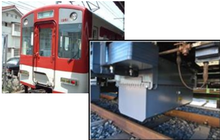
営業列車による軌道自動測定
