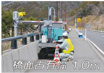
システム占有幅1.0mで通行車両への支障を回避できます。
