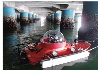
無線LANボートによる栈橋下面の調査状況
