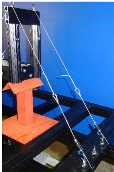
※吊橋形式の場合は、上記写真のようにケーブルを調整用ワイヤーに繋ぐ方式のみとします。凧糸・針金などを模型から張り出すなどして、支給材料の中で工夫してください。
