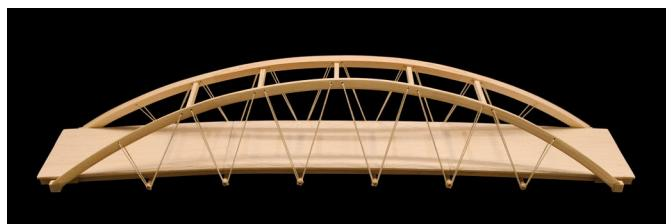
実際のアーチ橋のデザインを参考にするだけでなく、荷重の流れ方を再現することを目標として製作しました。また、アーチリブをヒノキの角材を曲げて製作することに挑戦しました。審査委員の方々から、構造の合理性や審美性にこだわったところを高く評価していただき、大変嬉しく思いました。
